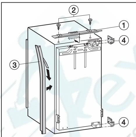
■ Установите рамку крепления ① и привинтите ее к прибору шурупами ② (3,5 x 8 мм, большая головка).
