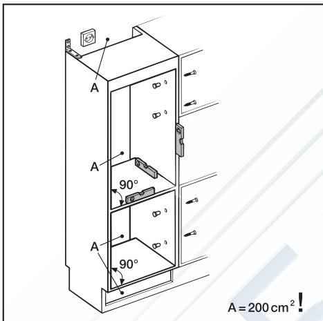
Перед встраиванием прибора тщательно выравните отвесами нишу для встраивания. Все углы должны быть ровно  $90^{\circ}$ , иначе мебельная дверь не будет ровно прилегать по углам.
